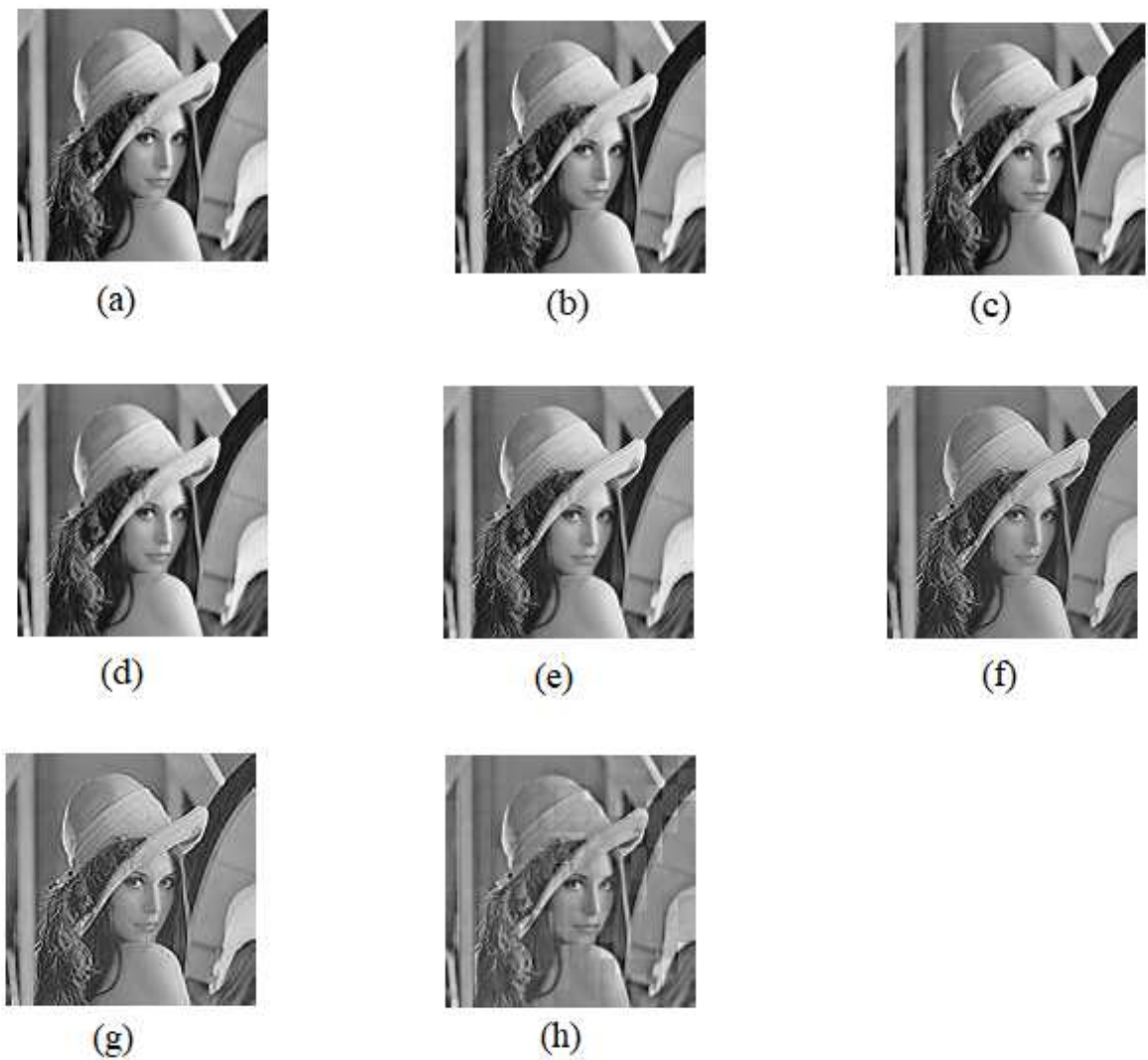
Fig. 5.8 Retrieved images with Algorithm 1 for different embedding rate: (a) 1/64 bpp (b) 1/32 bpp (c) 1/16 bpp (d) 1/8 bpp (e) 1/4 bpp (f) 1/2 bpp (g) 3/4 bpp (h) 63/64 bpp
