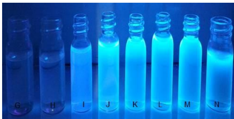
Figure 3. Fluorescence of Ugi EML BLUE in G) pH 2.3, H) pH 3.6, I) pH 7.2, J) pH 8.2, K) pH 8.4, L) pH 8.5, M) pH 8.7, N) pH 9.3
